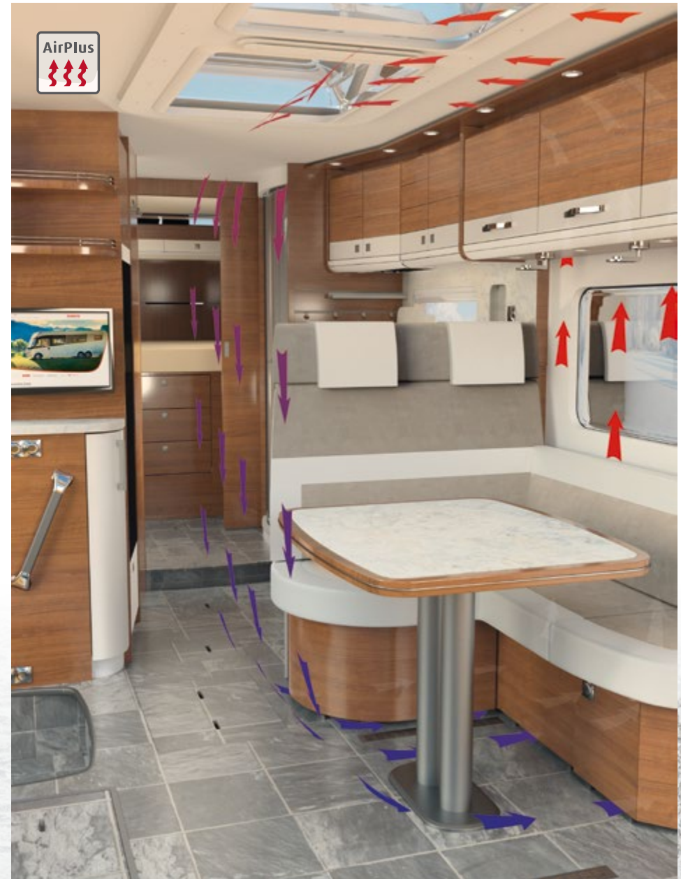
Das AirPlus-System verhindert die Bildung von Kondenswasser
