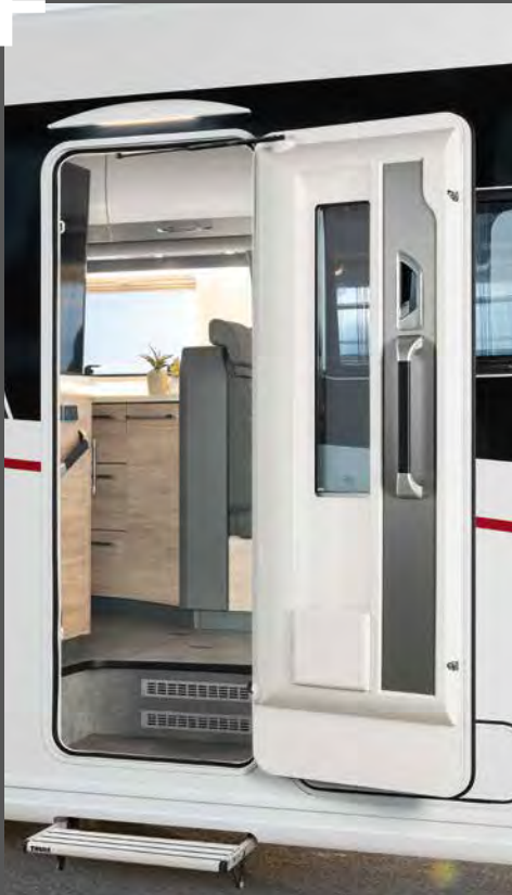
70 cm breite Türe mit Fenster, Zentralverriegelung und elektr. Zuziehhilfe.
